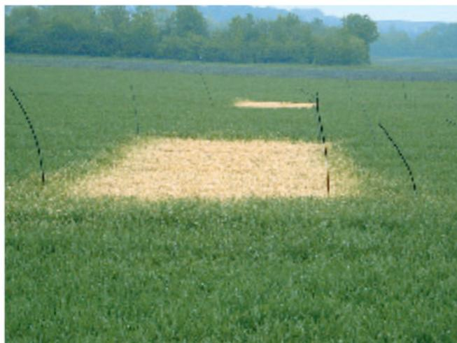
*Feintropfige Applikation bei Windstille mit 10 % Feintropfenvolumen (XR 110 03). Bei der feintropfigen Applikation ist die Übergangszone selbst bei Windstille ca. 1 m breit.*
