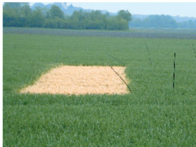
*Grobtropfige Applikation bei Windstille mit 1 % Feintropfenvolumen (ID 120 02). Die Übergangszone ist reduziert auf 10 cm. Behandelt wurde mit dem heute nicht mehr zugelassenen Paraquat.*
