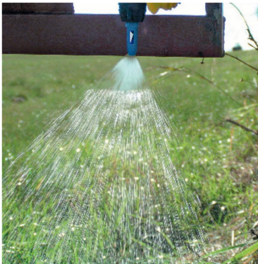
*Die Randdüse erzeugt einen seitlich abgeschnittenen, exzentrischen Spritzfächer und reduziert die Arbeitsbreite, so dass nicht mehr über die Feldgrenze hinaus gespritzt wird.*
